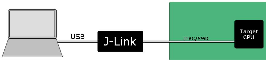
Для доступа к разъемам интерфейсов «JTAG» или «SWD» узлов требуется частичная разборка аппарата. Для подключения J-Link к узлам в зависимости от разъема программирования узла может потребоваться переходник IDC.
